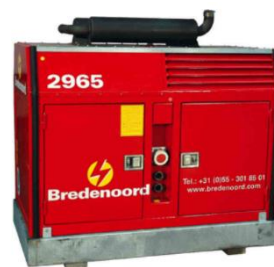
Figur 10 - Generator til HVO diesel
