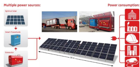
Figur 9 - Kombineret solcelleanlæg med batteri og kompressor fra www.bredenoord.com
