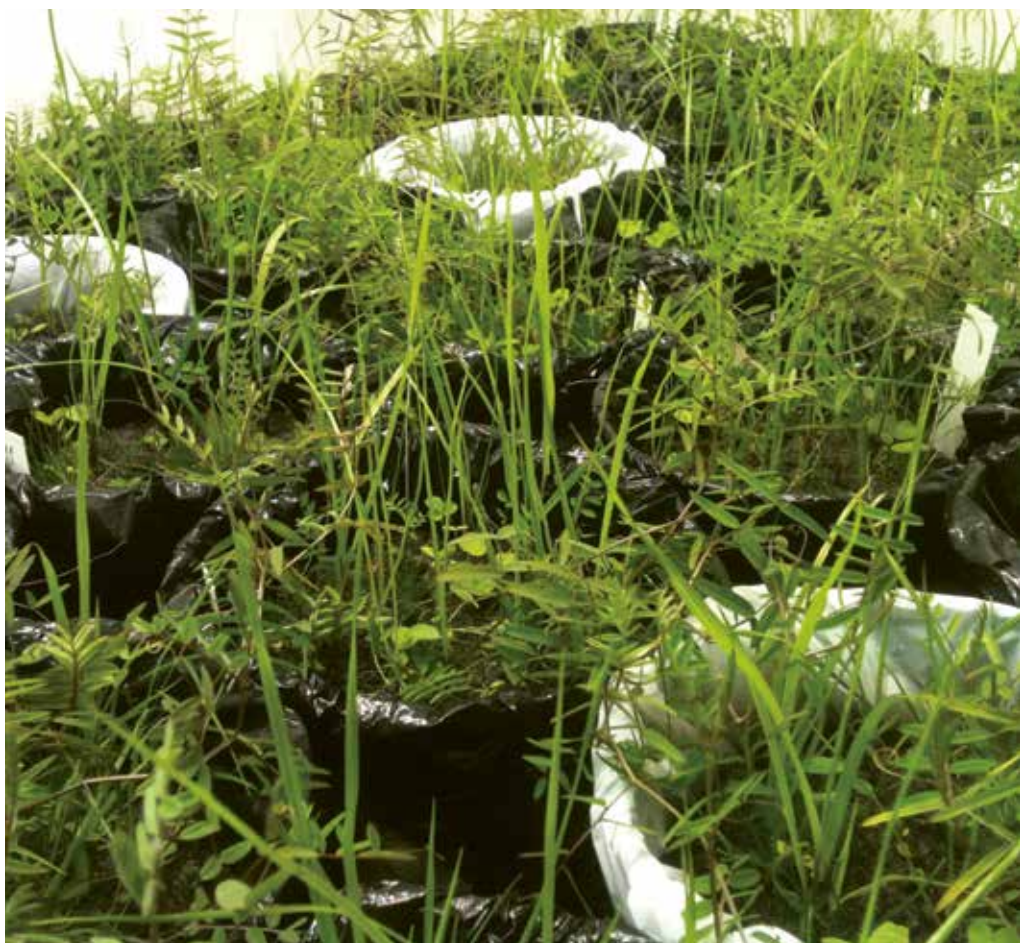
Figur 2. Potter med fangafgrøde (blodkløver, vikke og rajgræs) i vækstkammer, hvor jordtemperaturen blev holdt konstant på 12°C.
