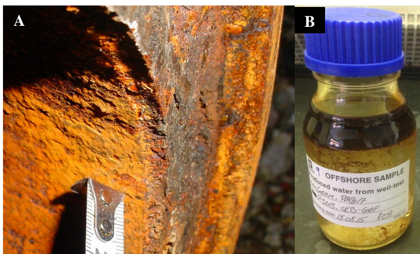
Figur 2: Prøverne fra rørlægninger (A) blev taget af det porøse rust på indersiden af røret. Prøver af vand blev udtaget i 250 mL flasker (B). Producerede vand havde en oliefase (øverst) og vandfase (nederst). Kun vandfasen blev analyseret.
