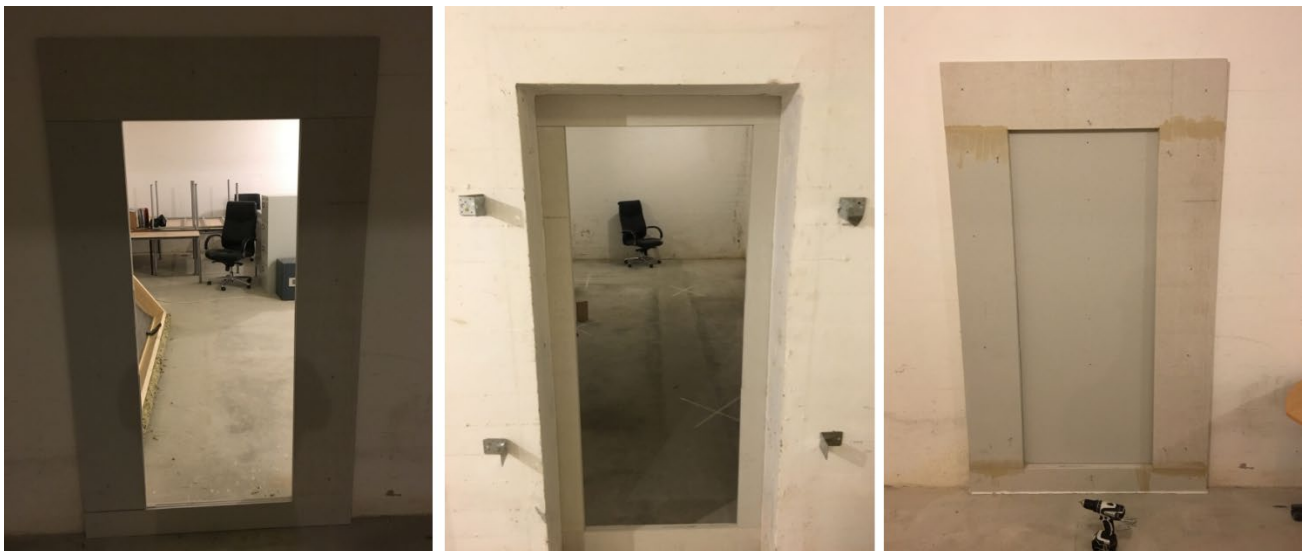
Foto 27 - Montering af testemne i døråbning
