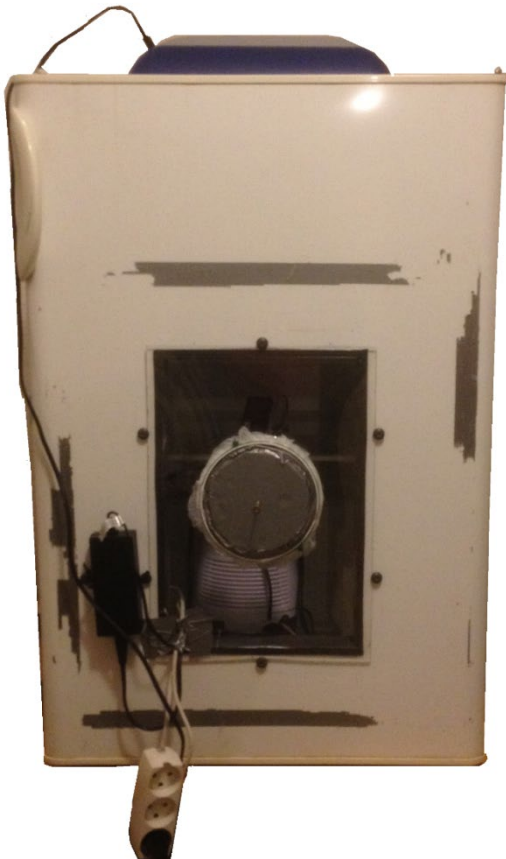
Foto 21 – Forsøgsopstillingen i rummet med Guarded Hot Box
