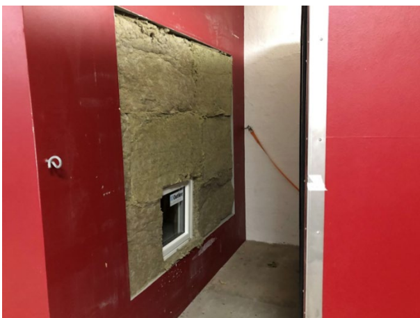
Foto 13 - Forsøgsopstilling i Guarded Hot Box
