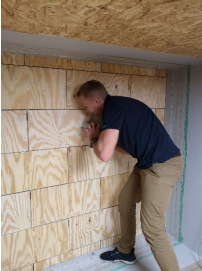
Foto 12 - Væg monteres i Guarded Hot Box
