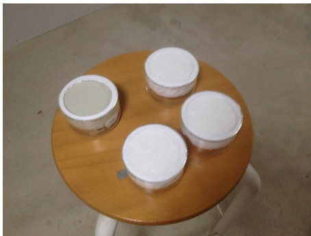
Foto 20 - 4 "kopper" med saltvand og testemner øverst
